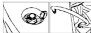
4. Nafukování spusťte stiskem tlačítka „Bubble“ a nafukujte dokud se ručička na manometru nedostane do zeleného pole těsně před hodnotu 0,65. Pak stiskem tlačítka „Bubble“ uzavřete přívod vzduchu. Tím se nafukování ukončí.
