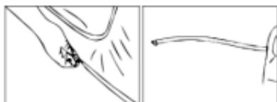
6.3. Otevřete vývod na vnější stěně vířivky. Našroubujte na něj jeden konec nafukovací hadice.
