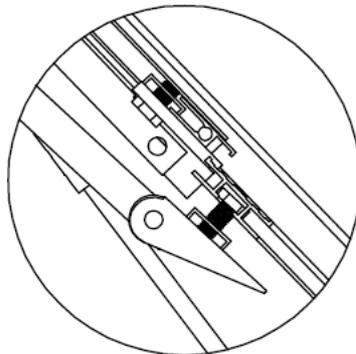
3. Posuňte válec (1) v matici (8), tak aby píst (7) tlačil na hliníkovou trubku (5). Až bude otvor v pístu (7) a hliníková trubka (5) v jedné linii dejte je do čepu (6).
