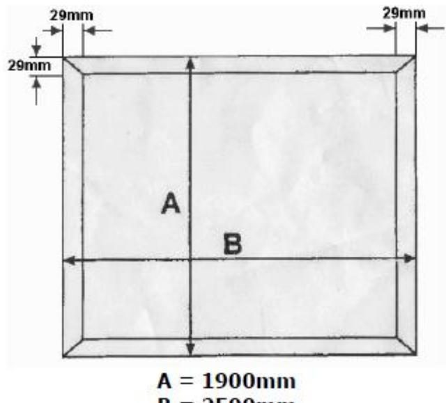
Hliníkové tyče jsou připevněné na dřevěné lamely (29 x 18 mm). Hliníkové tyče přišroubujte k hliníkovému rámu za pomocí 50 mm šroubů pod pevným úhlem – viz nákres.
