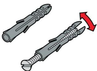
V balení poliček se nacházejí **univerzální hmoždinky** (viz obrázek). Tyto klasické nylonové hmoždinky jsou vhodné do **stěn z betonu nebo cihel**. Po našroubování a utažení vrutu se hmoždinka roztáhne a pevně se zachytí ve zdi. Příklepovou vrtačkou vyvrtejte otvor, zasuňte do něj hmoždinku a jemně ji doklepněte, aby nevyčnívala ze zdi. Nyní můžete našroubovat vrut.
