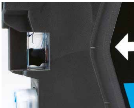
Bez čipu. Patrony Brother mají ke kontrole hladiny inkoustu malé okénko.
