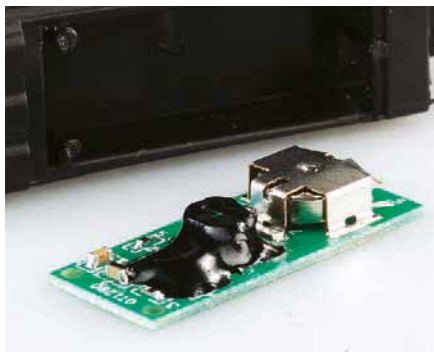
Čip s baterií Alternativní patrony pro Epson s vlastním zásobováním proudem.
