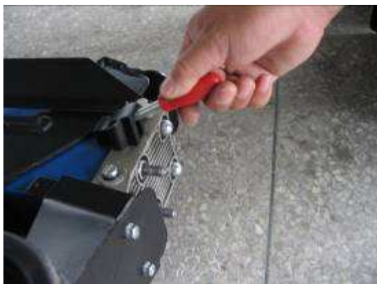
b) Nasadte dva otvory bezpečnostního krytu na dva šrouby na konci stroje. (Obr. 5)
