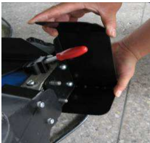
c) Použijte dva šrouby, gumové a ploché podložky a dotáhněte obě matice k tělu stroje. (Obr.6)
